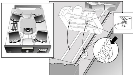
13. Inserte la clavija en la parte inferior del cargador de cartucho en la ranura de la correa y, a continuación, gire el cargador hasta asegurarlo en la correa.
