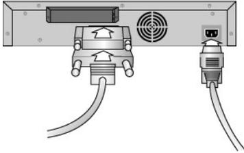
Si el cable SCSI incluido en el equipo no se ajusta al conector del adaptador de host SCSI, significa que su adaptador es incompatible, o bien que debe comprar un adaptador de cables. Para obtener más información, póngase en contacto con su representante de atención al cliente o con el fabricante de su adaptador de host SCSI.
