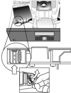
10. Después de haber quitado los cartuchos de los cargadores, vuelva a instalar cada cargador en la correa del cargador automático (consulte la sección "[Instalación del cargador de cartuchos](#)").
