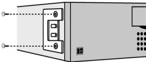
5. Si el cargador automático tiene soportes de instalación (unidad montada en bastidor), retire los cinco tornillos en la parte posterior del cargador automático y los dos tornillos adicionales en cada panel lateral para soltar la cubierta del cargador automático. Para una unidad externa, retire los tornillos de la cubierta frontal y los tres tornillos adicionales en cada panel lateral de la unidad.
